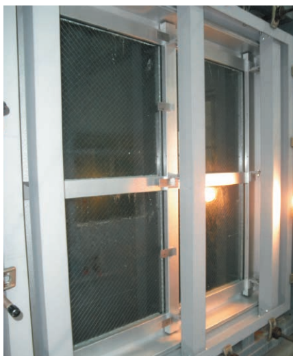
▲アルミ押さえタイプ (RC-GAシリーズ) 単板ガラスタイプ 水密性能試験風景
