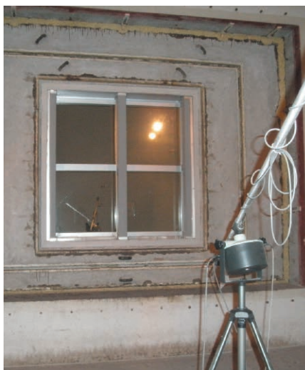
▲アルミ押さえタイプ (RC-GAシリーズ) 複層ガラスタイプ 遮音性能試験風景
