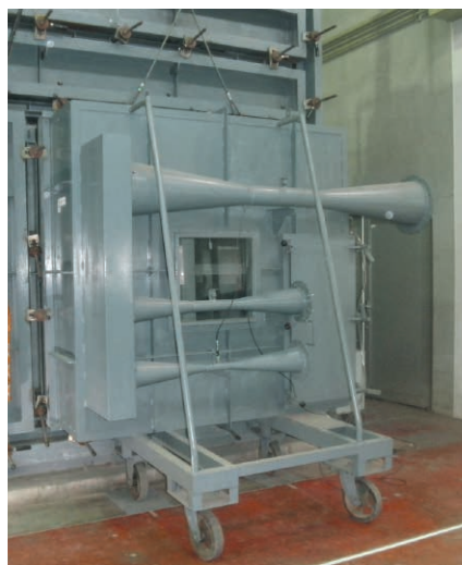
▲アルミ押さえタイプ (RC-GAシリーズ) 複層ガラスタイプ 気密性能試験風景
