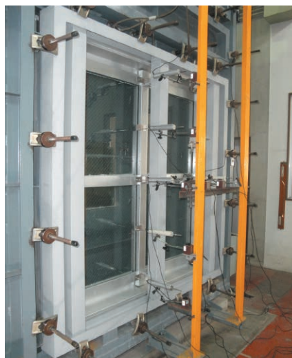
▲アルミ押さえタイプ (RC-GAシリーズ) 単板ガラスタイプ 耐風圧性能試験風景
